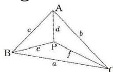
$$a^2 d^2 (b^2 + c^2 + e^2 + f^2) - a^2 d^4 - a^4 d^2 + b^2 e^2 (a^2 + c^2 + d^2 + f^2) - b^2 e^4 - b^4 e^2 + c^2 f^2 (a^2 + b^2 + e^2 + d^2) - c^2 f^4 - c^4 f^2 - a^2 b^2 c^2 - a^2 e^2 f^2 - b^2 f^2 d^2 - c^2 d^2 e^2 = 0 \dots \textcircled{1}$$
